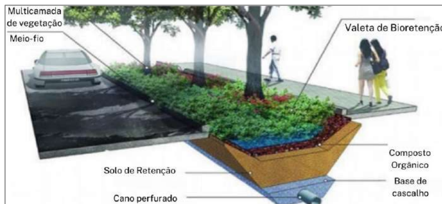
FIGURA 9 – CONFIGURAÇÃO ESQUEMÁTICA DE UMA BIOVALETA. FONTE: DAVIDOVITSCH ET AL, 2024.
