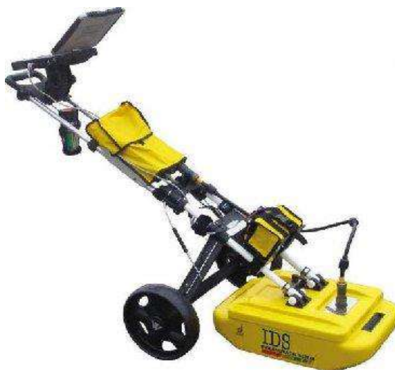
FIGURA 5 – EQUIPAMENTO GPR IDS DUAL FREQUENCY COM ANTENA QUE OPERA EM 250 E 700MHZ E HODÔMETRO ACOPLADO.FONTE: IDS, 2023.
