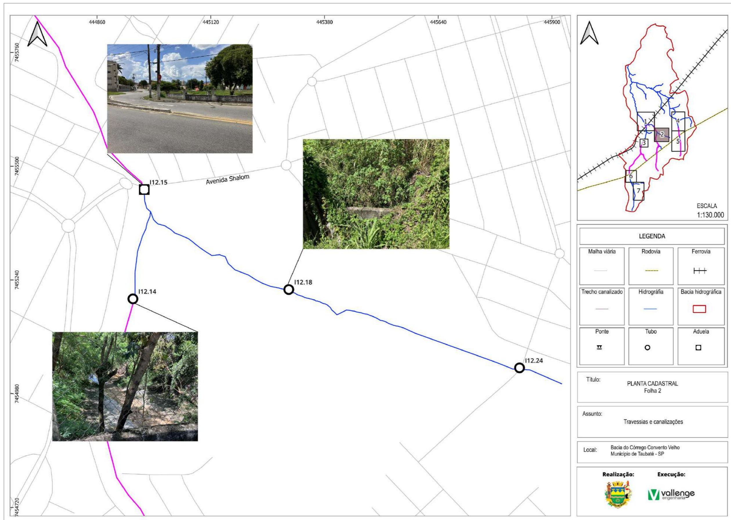
FIGURA 59 – PONTOS DE INTERFERÊNCIA EM TRAVESSIAS E CANALIZAÇÕES DA BACIA HIDROGRÁFICA 12 - CÓRREGO CONVENTO VELHO (FOLHA 2) FONTE: ELABORADO PELO AUTOR, 2024.
