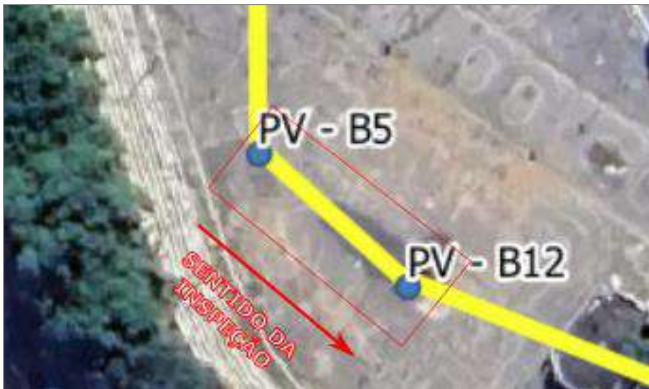
FIGURA 39 – TRECHO REFERENTE AO INÍCIO NO PV B5, COM LIMITE DA INSPEÇÃO NO SENTIDO DO PV B12. ELABORADO PELO AUTOR, 2023.
