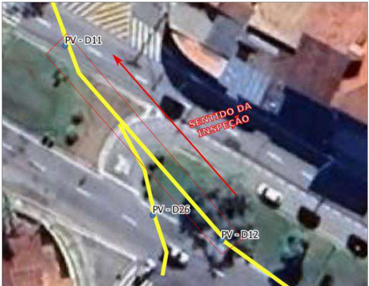
FIGURA 119 – TRECHO REFERENTE A ENTRADA PELO PV D12, NO SENTIDO DO PV D11. ELABORADO PELO AUTOR, 2023.
