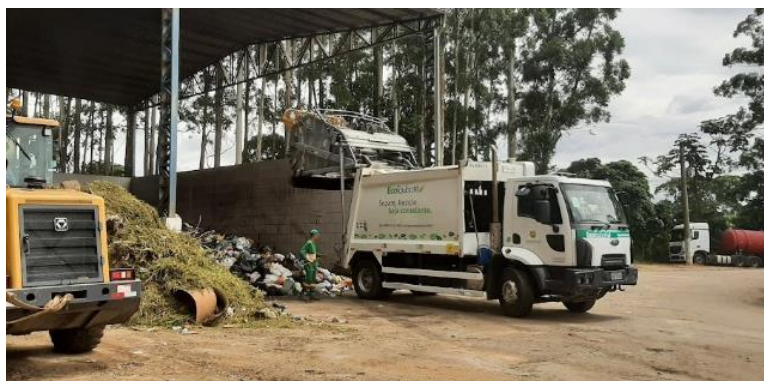
Figura 115: Caminhão compactador descarregando os resíduos na unidade de Transbordo.
