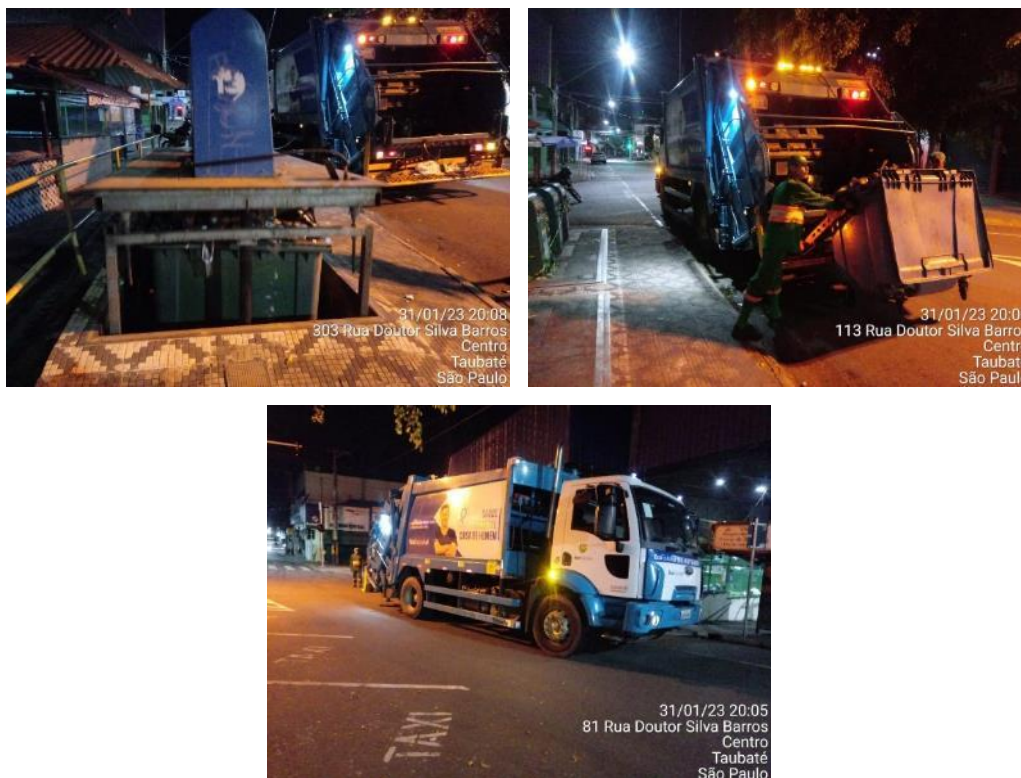
Figura 52: Coleta mecanizada dos contentores soterrados.
