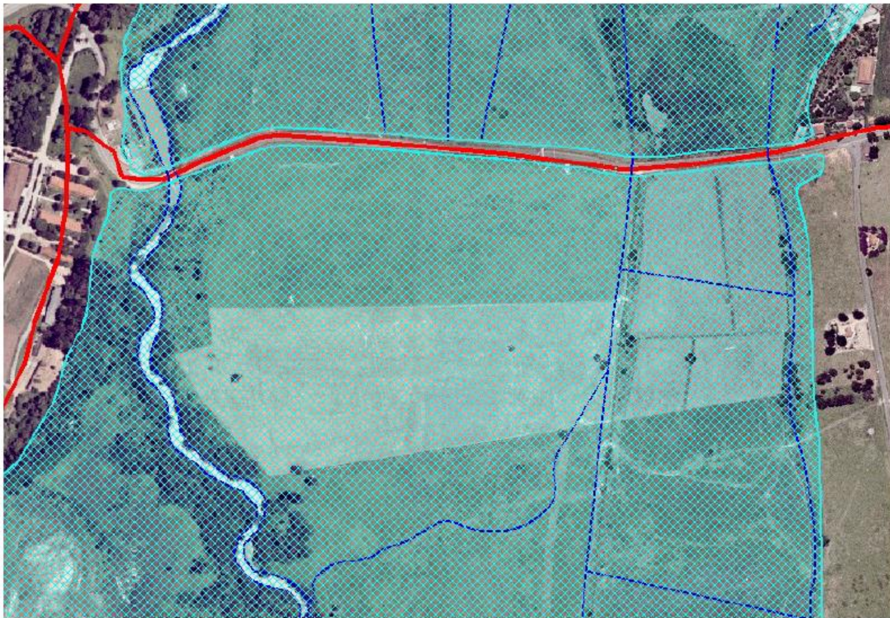
Figura 143. Mancha de inundação calculada à montante da ponte sobre o rio Una na Estrada Dr. José Luiz Cembranelli.
