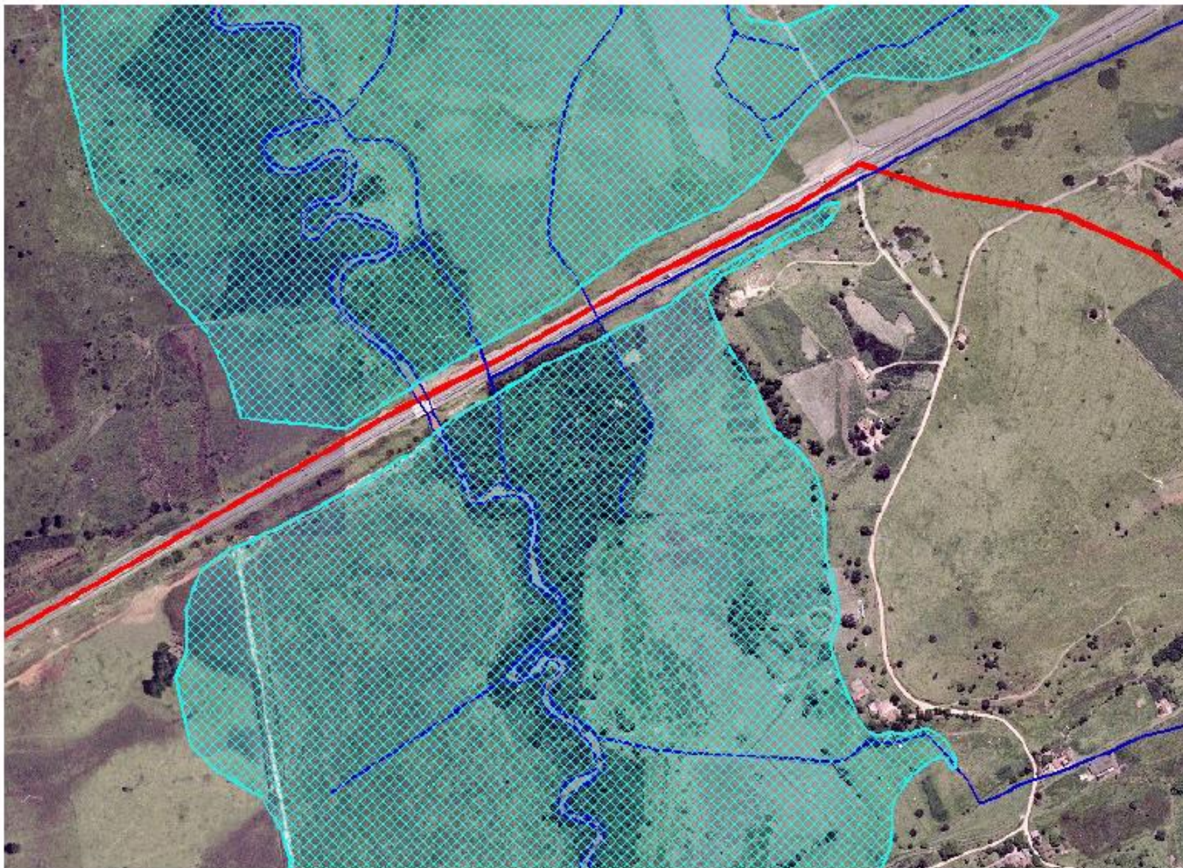
Figura 140. Vista da abrangência da mancha de inundação calculada à montante da estrutura hidráulica da Rodovia Presidente Dutra sobre o rio Una.
