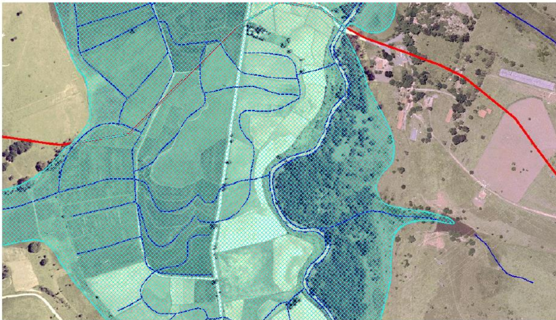
Figura 144. Mancha de inundação calculada à montante da ponte sobre o rio Una na Estrada dos Remédios.
