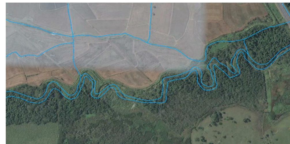
Meandro divagante à jusante da rodovia Presidente Dutra, junto alterações de drenagem para sistematização das várzeas
