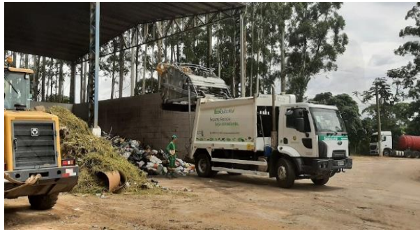
Figura 115: Caminhão compactador descarregando os resíduos na unidade de Transbordo.
