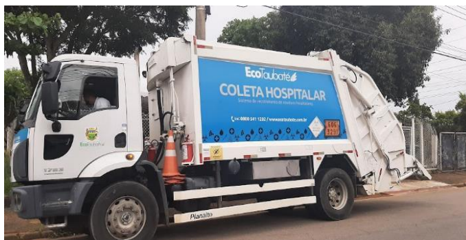
Figura 93: Caminhão compactador de coleta de RSS.
