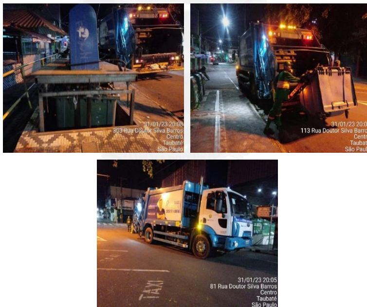
Figura 52: Coleta mecanizada dos contentores soterrados.
